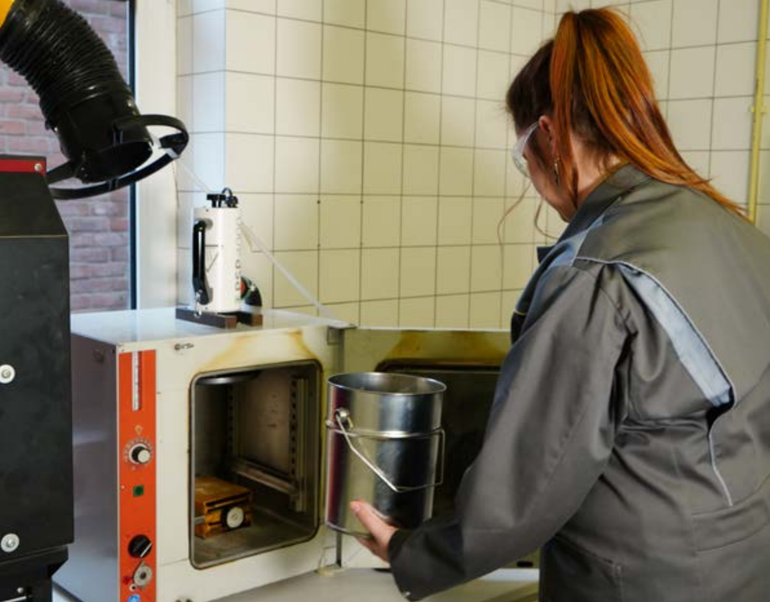
Foto 6: Formaldehyd-Emissionsmuster bei 150°C im Trockenschrank
