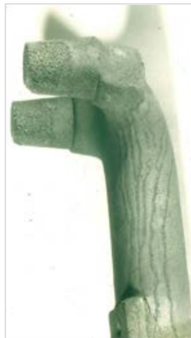
Foto 3. Synerese Erscheinung bei Verwendung von Schlichte mit Bakterienbefall
