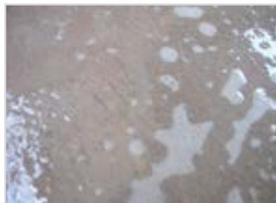
Foto 1. Mit Bakterien infizierter Schlichtebehälter
